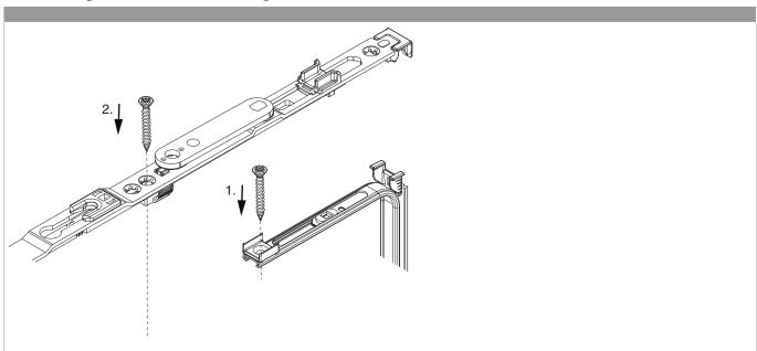
Zuerst Eckumlenkung senkrecht einsetzen und in den Nutgrund verschrauben (1), danach Scherenstulp in Eckumlenkung einklipsen und verschrauben (2).
